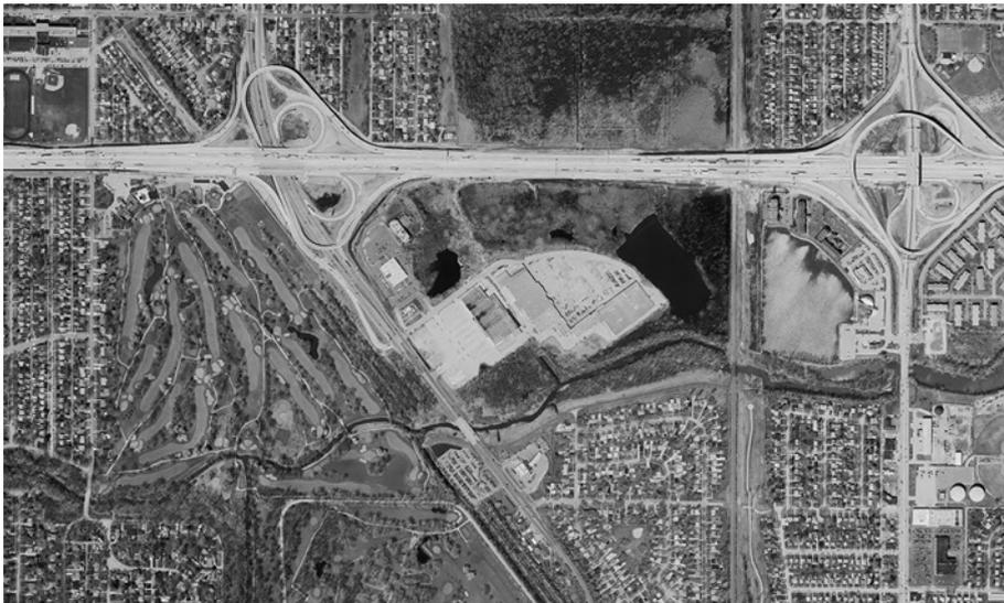
사진 3. 극심하게 변형·훼손된 하천변 습지. 미국 중서부 인디애나주의 북서부 하몬드시(Hammond) 근처에 위치한 하천, 리틀 칼류멧 강(Little Calumet River) 주변 지역의 항공사진이다. 하천과 습지는 제방에 의하여 격리되었고, 매립 및 배수된 습지는 한때 농경지로 전환된 적이 있었으나, 현재는 골프장, 쇼핑몰, 고속도로, 그리고 주택들이 들어섰다. 또한 준설로 인하여 수심이 깊어진 못도 보인다 (사진 출처: Indiana State Department of Natural Resources).
